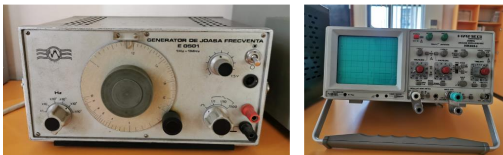
Fig. 5 – Generatorul de impulsuri repetate și osciloscopul Hameg HMG 303-6 utilizate pentru realizarea montajului experimental
